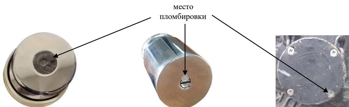
Рисунок 7 – Схема пломбировки гирь цилиндрической формы с номинальным значением массы от 0,1 кг до 500 кг
