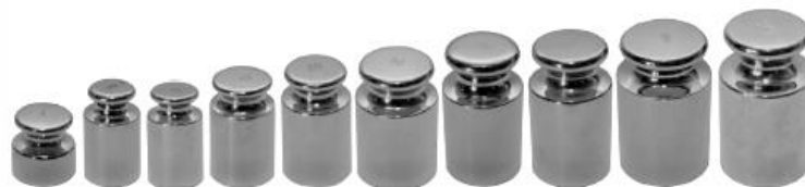
Рисунок 1 – Общий вид гирь с номинальным значением массы от 0,001 кг до 20 кг классов точности F_1 , F_2 и гирь с номинальным значением массы от 0,1 кг до 20 кг класса точности M_1
