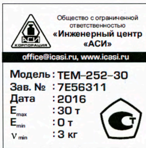
Рисунок 2 - Маркировочная табличка датчика весоизмерительного тензорезисторного TEM-252
